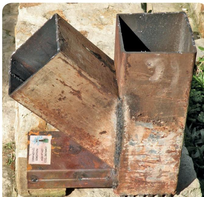
Sistema de ingreso de leña, cámara de combustión e intercambiador de calor.
