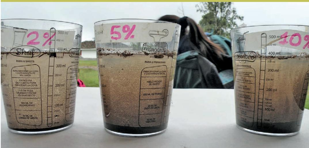
Observe en cuál caso hay menos erosión y decida la pendiente de sus propios drenajes en función de la estructura de sus suelos.
